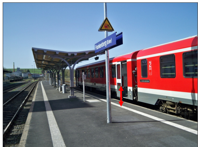
Einsatz von Altbaureihen (VT 628, VT 612) mit Trittstufen im Eingangsbereich
